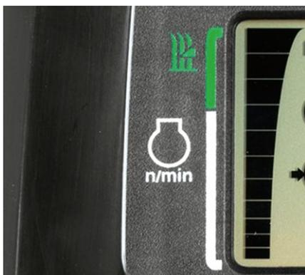
**Optimaler „Drehzahlbereich“:** Diese Anzeige stellt die für den Mähbetrieb optimale Motordrehzahl grafisch dar. Dadurch erzielen Sie immer herausragende Arbeitsergebnisse.
