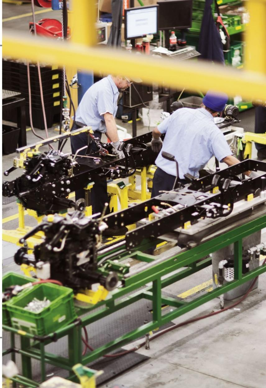
Zwei Mitarbeiter im Werk von Augusta bei der Montage eines Getriebes am hochfesten Stahlrahmen eines Kompaktraktors.
